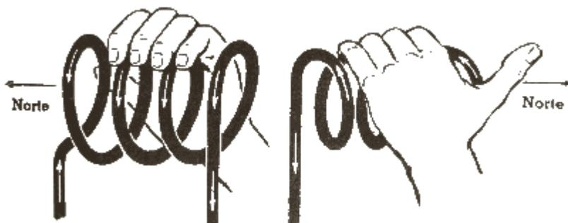
FIGURA 18. POLARIZACIÓN DE UN SOLENOIDE
