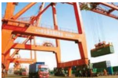
Designación: RTG - Grúas de pórtico con neumáticos de caucho Número: 16 Tonelaje: 40 toneladas
