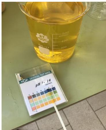
**Imagen 7.** Medición de pH a aceite de pollo mediante tiras reactivas.
