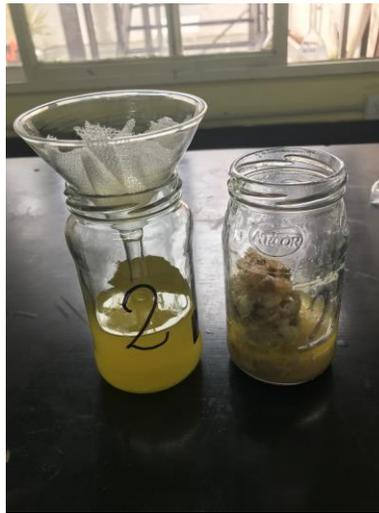
**Imagen 5.** Separación de grasa fundida con embudo y gasa.
