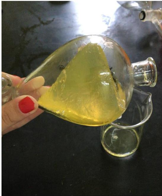
**Imagen 19.** Muestra de biodiesel gelatinizada.
