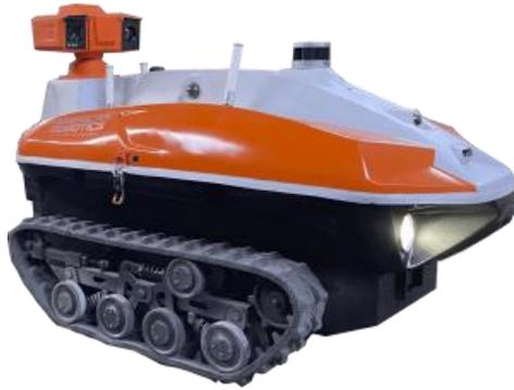
ROBOT UGV (Vehículo terrestre no tripulado). Fuente: Recuperado de AR Robotics S.A.
